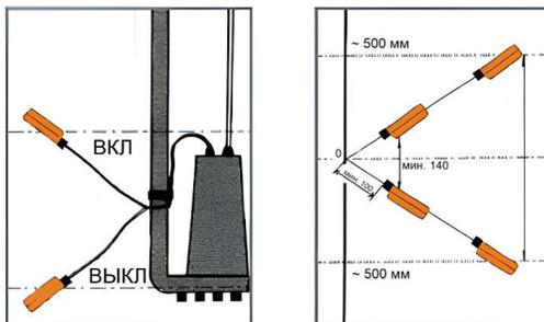
Кабель поплавкового выключателя должен быть жестко закреплен между необходимыми уровнями срабатывания.
